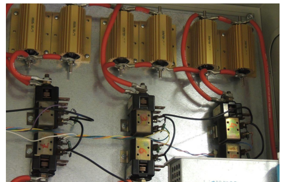
Resistenze corazzate per la simulazione dei circuiti elettrici di scarica.
