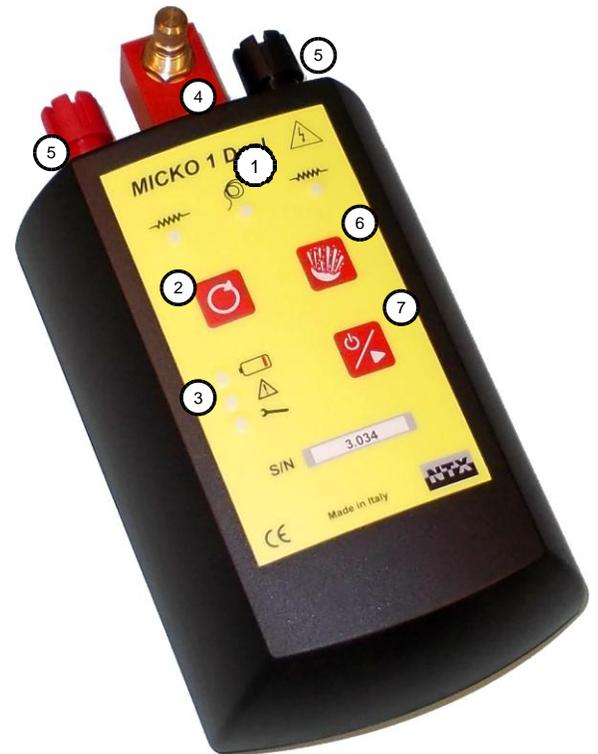
1. Светодиодные индикаторы: Показывают выбор режима: EL электрический детонатор или TC детонирующий шнур
